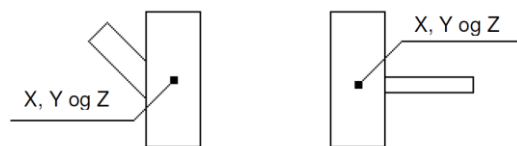
Figur 3. Innmåling av forgrening og an boring (plan)
