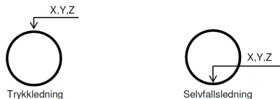
Figur 1. Måling av ledningshøyde
