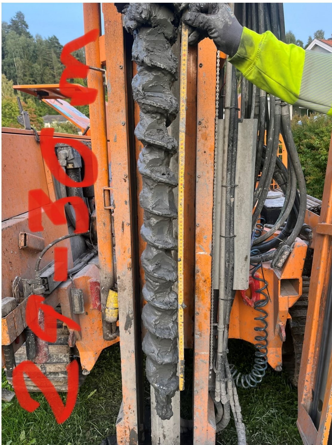
Figur D 13: Skovlboring ved 29-30 meters dybde i borpunkt 2A
