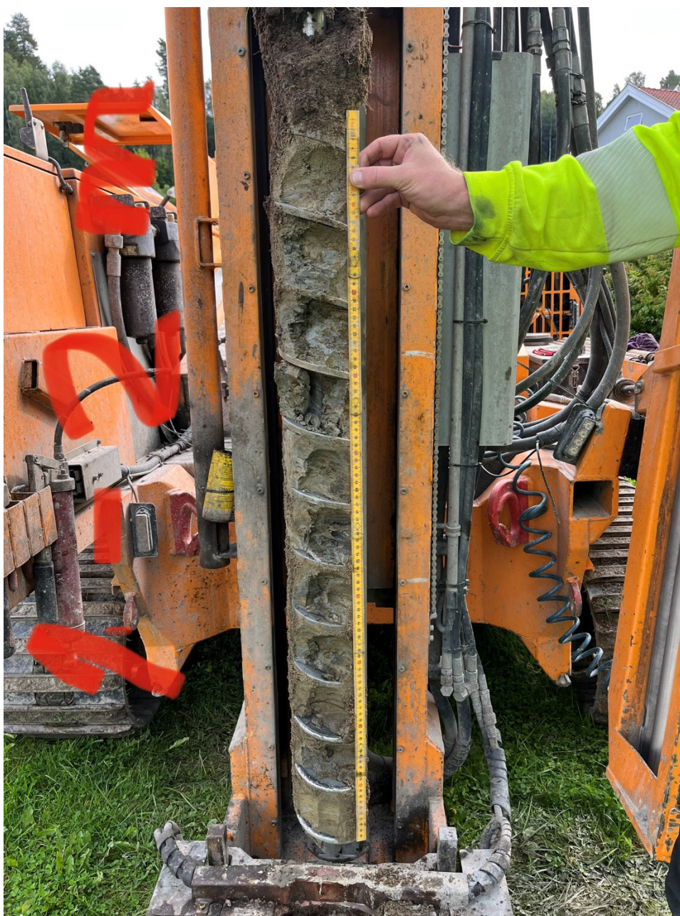
Figur D 1: Skovlboring ved 1-2 meters dybde i borpunkt 2A
