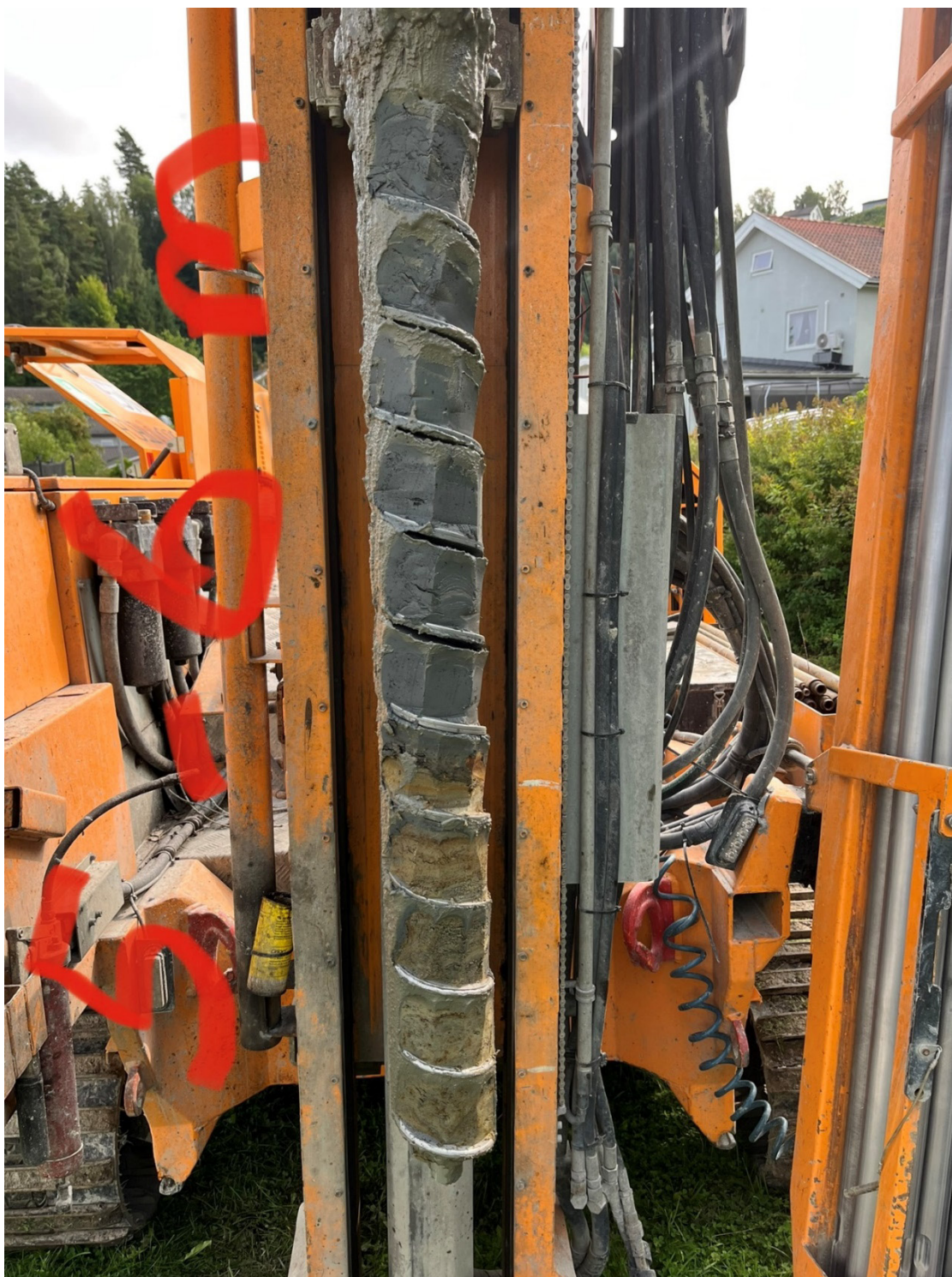
Figur D 5: Skovlboring ved 5-6 meters dybde i borpunkt 2A
