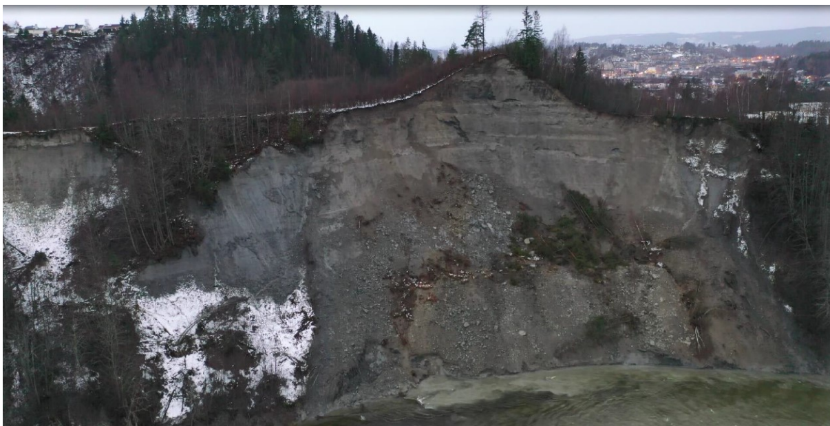
Figur 2: Den bratte sand/leirskråning sør for Hovsenga er området hvor skredet løsnet (utløsningsområdet). Dronebilde tatt av Jostein Nybråten 21. november 2019.
