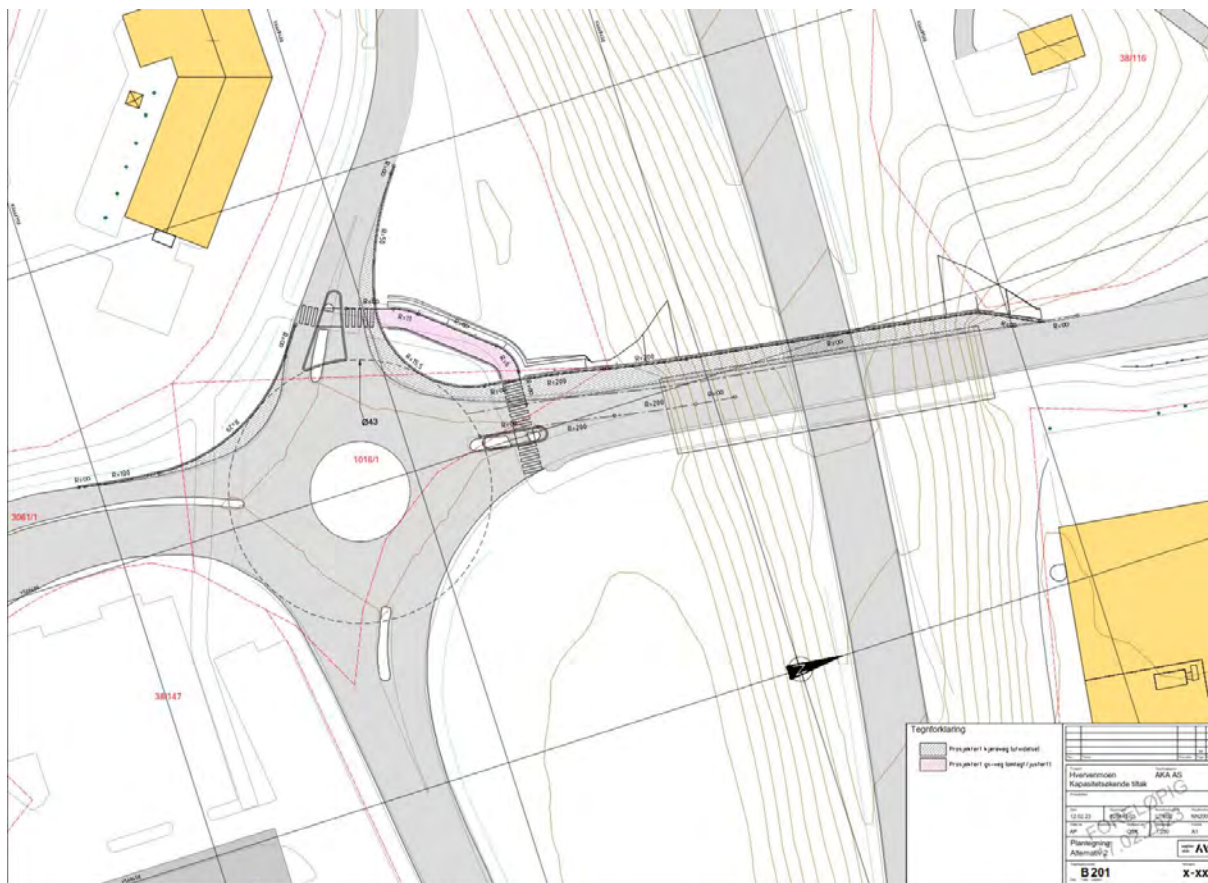
Figur 4-4. Utvidelse av Hvervenkastet inn i rundkjøringen
