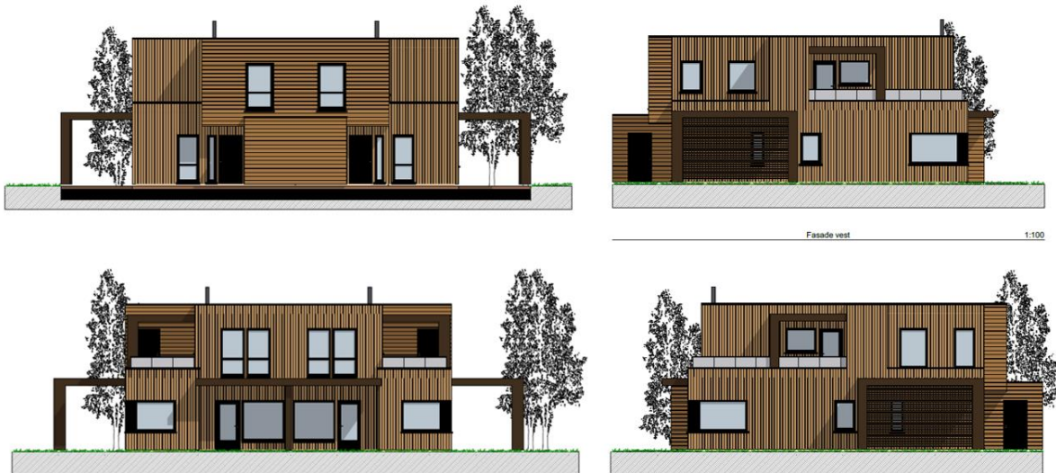
Tomannsbolig – modulbygg – fire fasader
