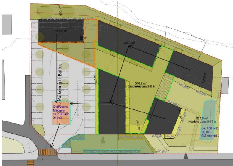
Utsnittet viser overvannsplan fra COWQ (2021). Blå skravur er nedsenkninger med fordrøyningsvolum på terreng. Oransje skravur er overvannsmagasin.
