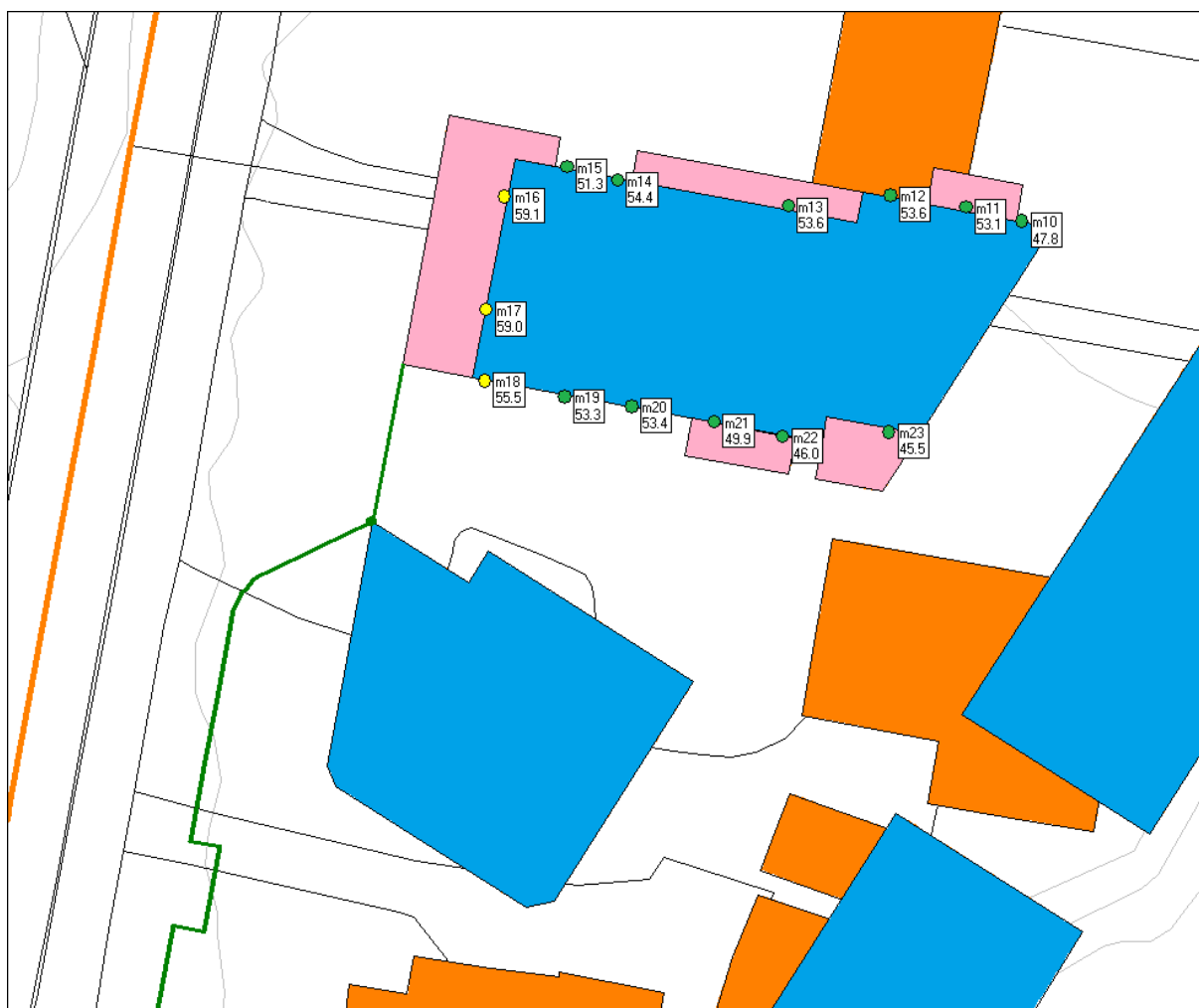
KART 15 KARTLEGGING AV STØY M/SKJERM 1,2 METER HØY, BYGG C 3. ETASJE, Lden
