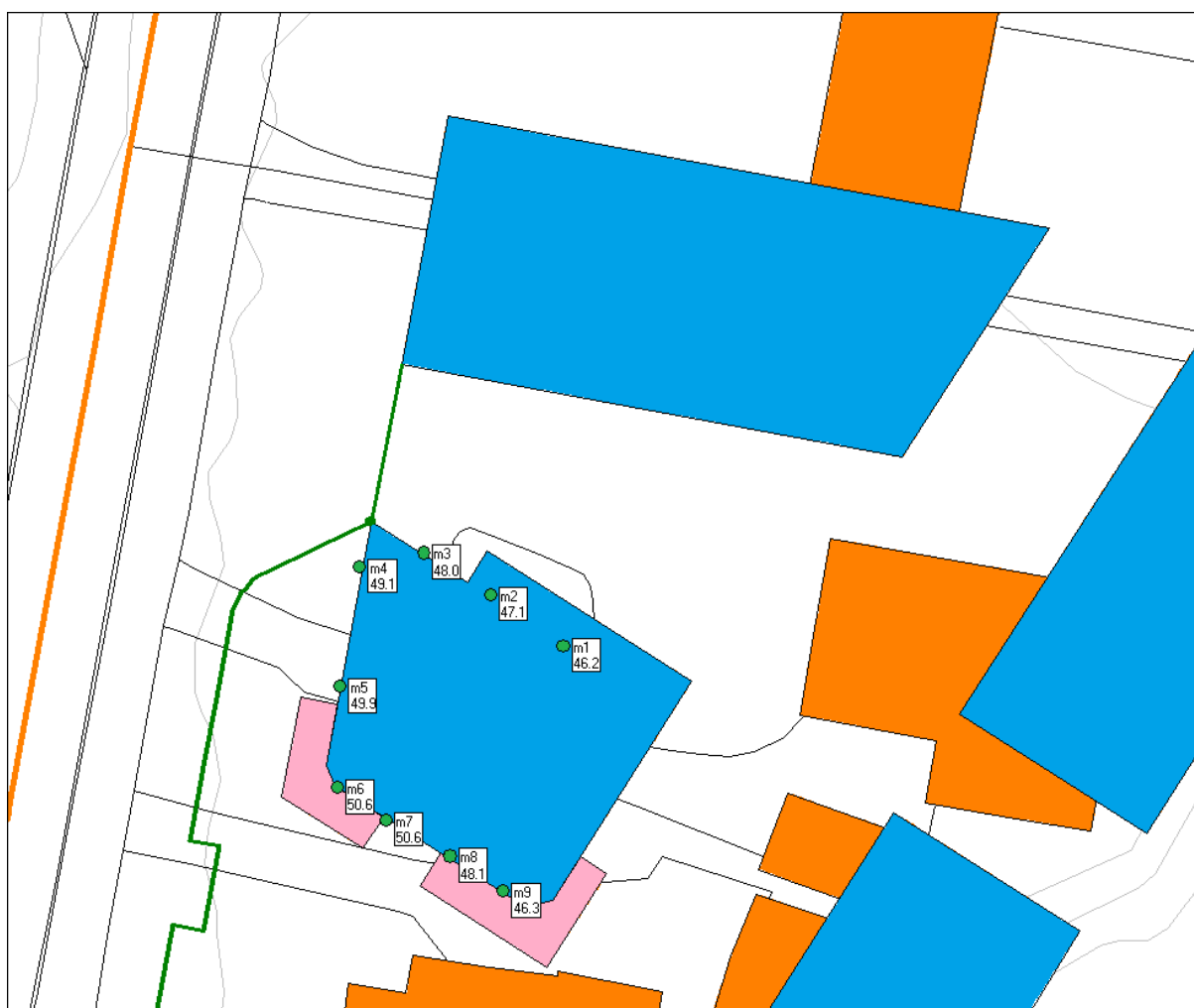
KART 9 KARTLEGGING AV STØY M/STØYSKJERM 1,2 METER HØY, BYGG B UNDERETASJE, LDEN
