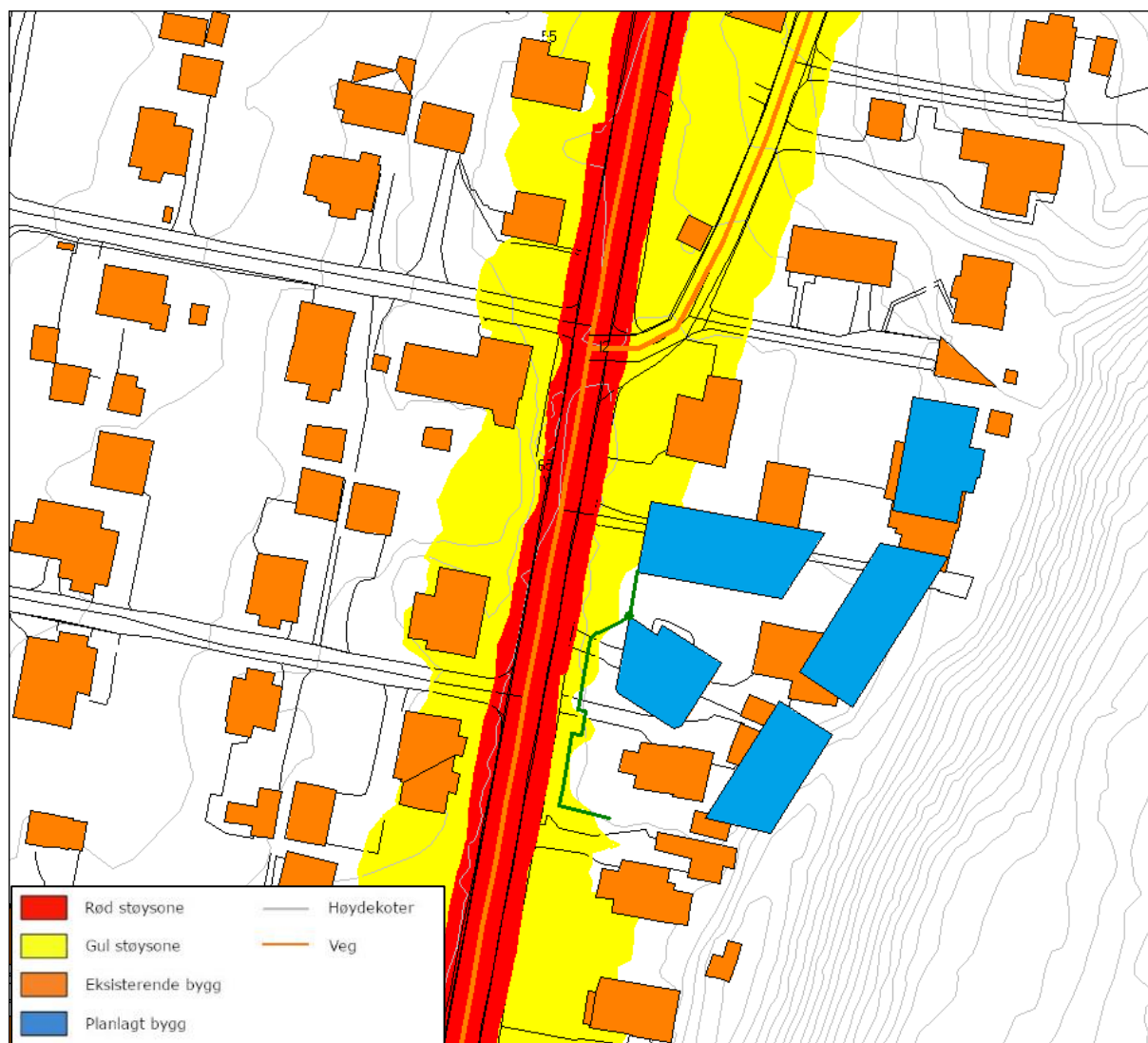
KART 10 STØYSONEKART, LDEN 1,5 M M/SKJERMING 2,5 METER HØY. SKJERMING 1,2 M MELLOM BYGG B OG C.
