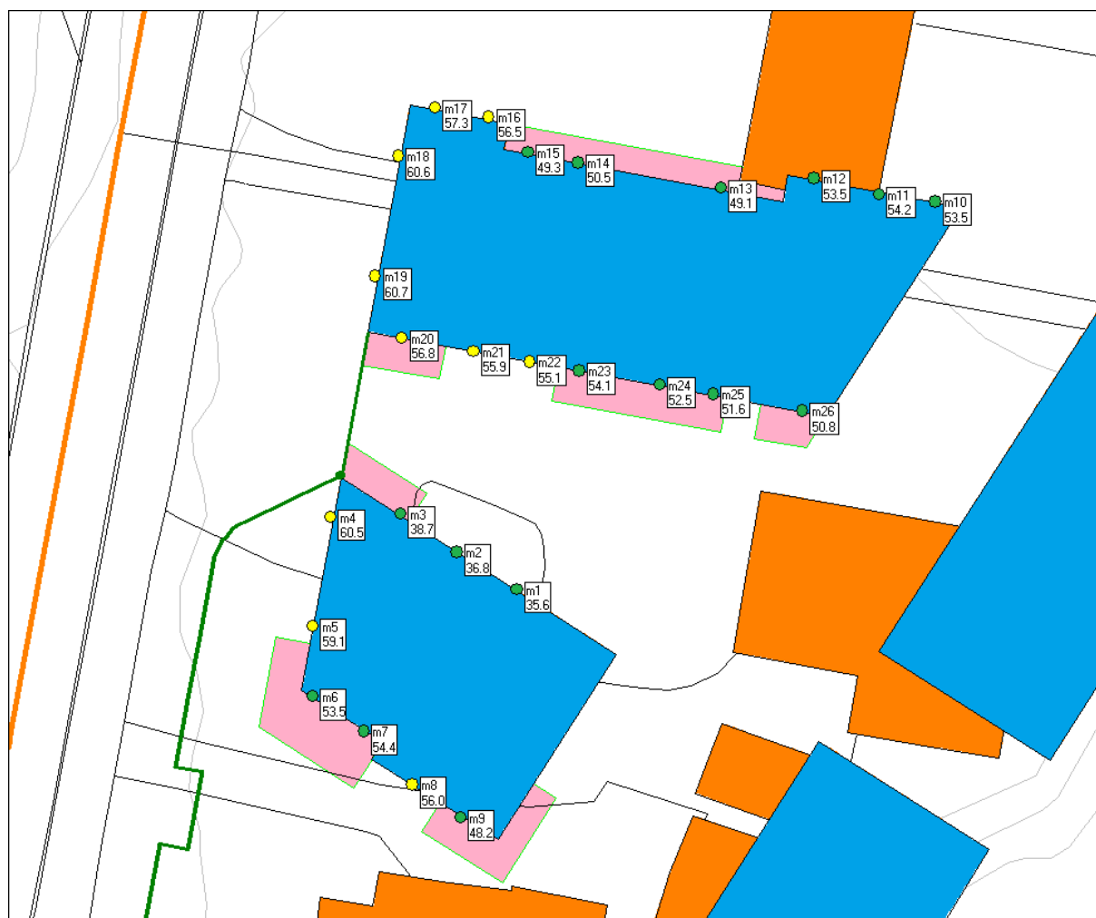
KART 19 KARTLEGGING AV STØY M/LOKALSKJERM 2,5 METER HØY, BALKONG VED PUNKT 20 TETT REKKVERK 1,2 M HØY. 1. ETASJE, LDEN
