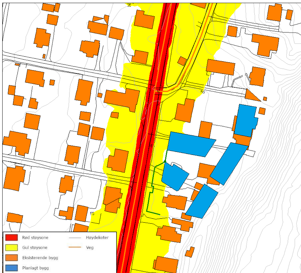
KART 9 STØYSONEKART, LDEN 4M M/SKJERMING 2,5 METER HØY. SKJERMING 1,2 M MELLOM BYGG B OG C.
