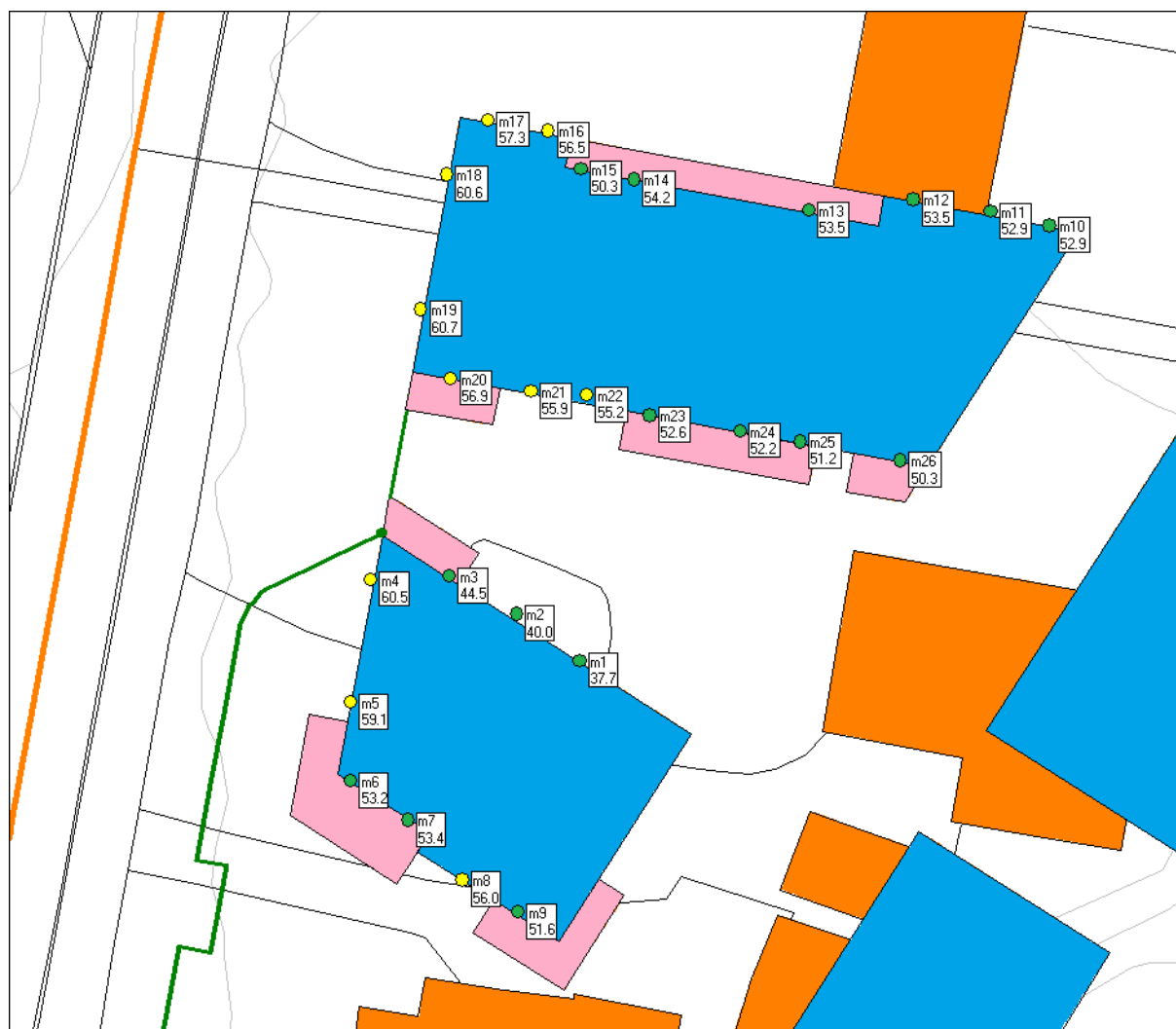
KART 17 KARTLEGGING AV STØY M/LOKALSKJERM 1,2 METER HØY, BALKONG VED PUNKT 20 TETT REKKVERK 1,8 M HØY. 1. ETASJE, LDEN
