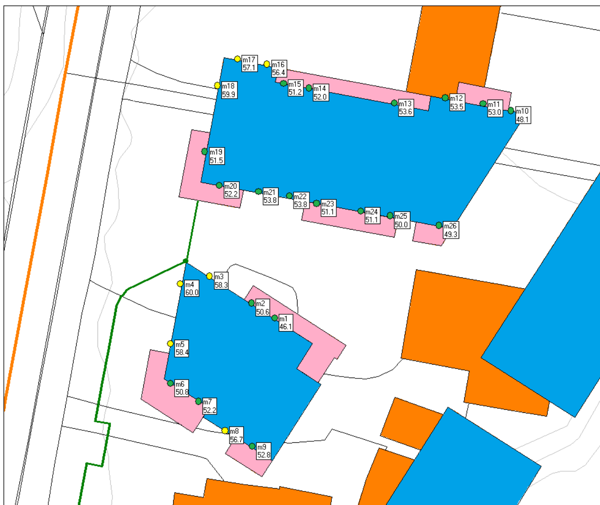
KART 13 KARTLEGGING AV STØY M/STØYSKJERM 1,2 METER HØY, BYGG B OG C 2. ETASJE, LDEN
