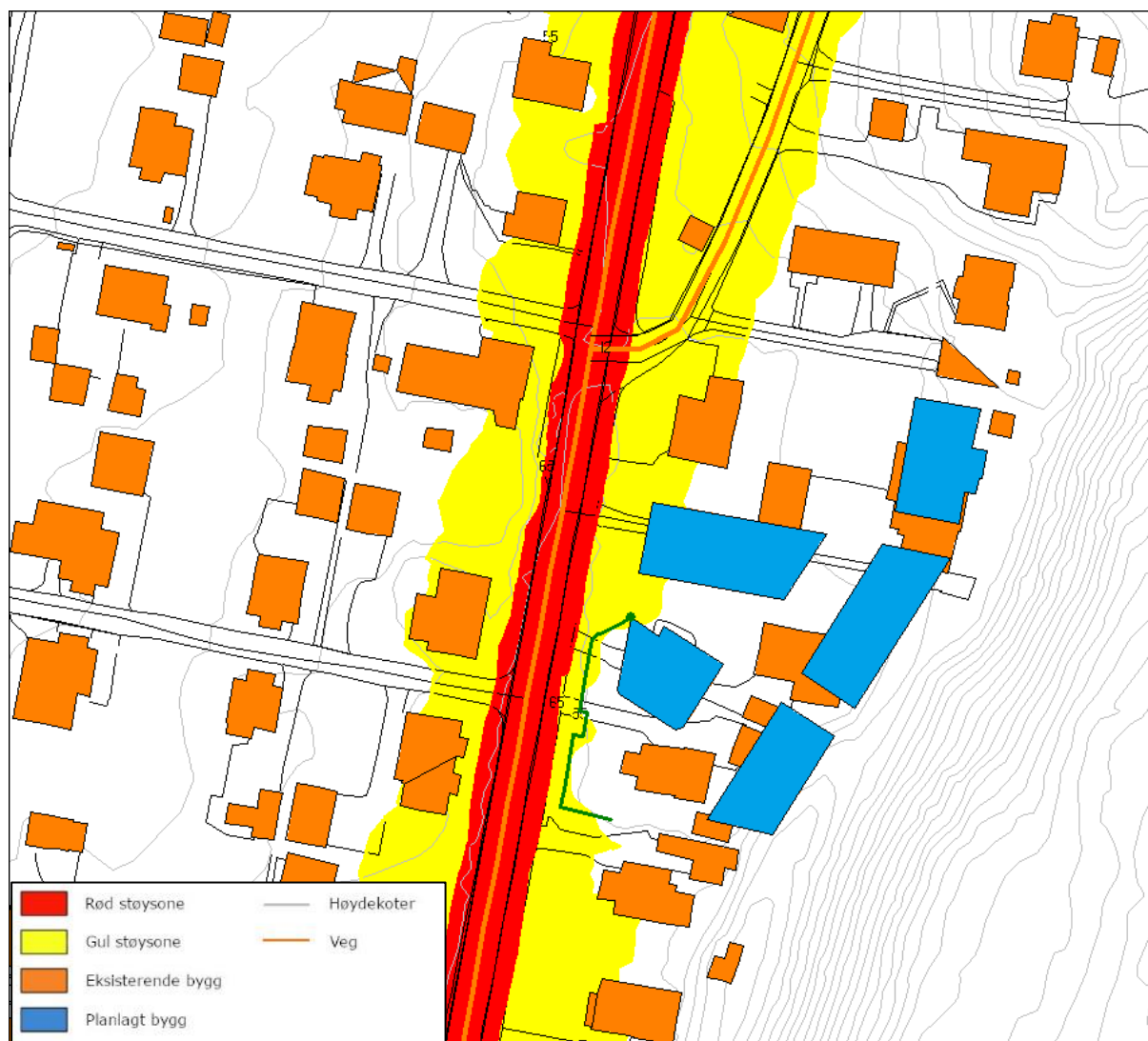
KART 8 STØYSENEKART, LDEN 1,5M M/SKJERMING 2,5 METER HØY
