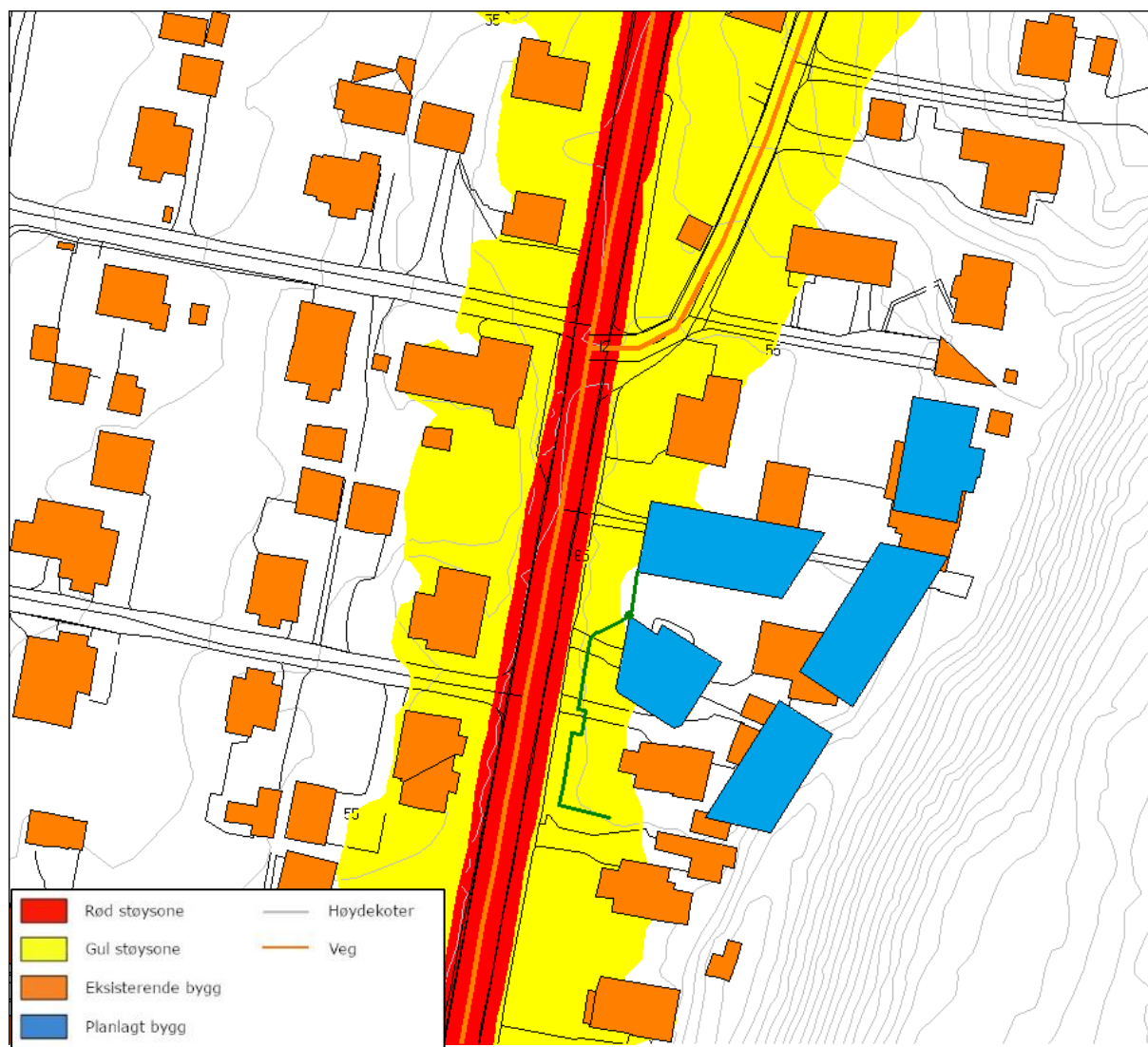
KART 11 STØYSONEKART, LDEN 4M M/SKJERMING 2,5 METER HØY. SKJERMING 2 M MELLOM BYGG B OG C.
