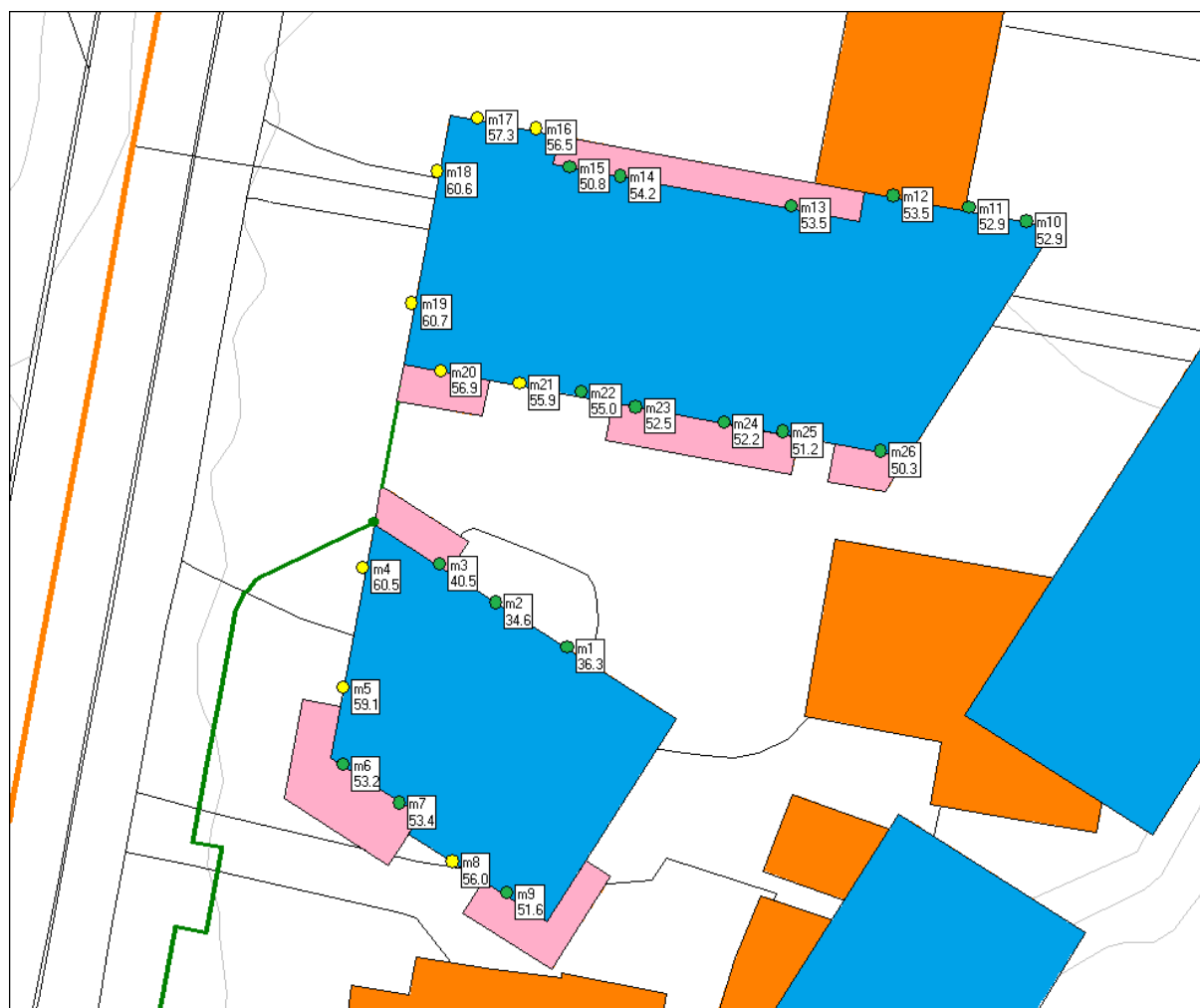
KART 12 KARTLEGGING AV STØY M/STØYSKJERM 2 METER HØY, BYGG B OG C 1. ETASJE, Lden
