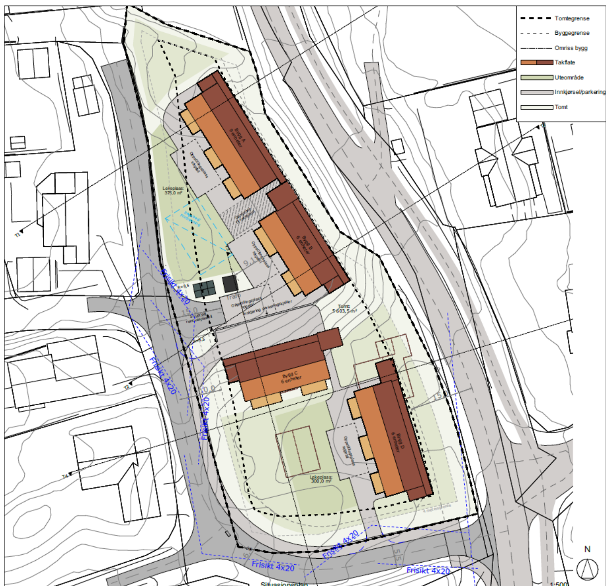
Figur 27: Situasjonsplan følger planforslaget og viser et forslag til utnyttelse av området som ligger innenfor rammene i planen (Tegning: Norgeshus AS)
