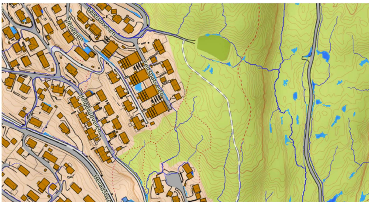
Figur 17: Dreneringslinjer i området. Tilrenningsarealet er om lag 1000 m 2 . Hentet fra Scalgo Live.
