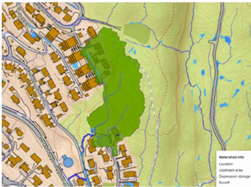
Fig. 47 – Nedbørsfeltet, arealet som har avrenning mot planområdet.
