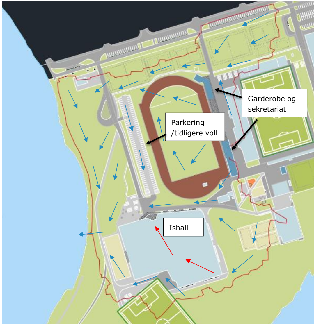
Figur 18: Deltfelt 10 - avrenningsmønster og tiltak
