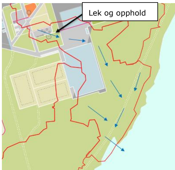
Figur 15: Deltfelt 5 - avrenningsmønster og tiltak
