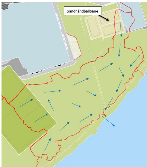
Figur 16: Deltfelt 6 - avrenningsmønster og tiltak
