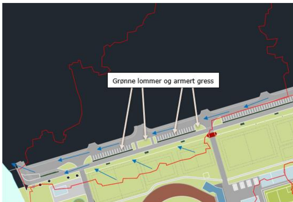
Figur 11: Delfelt 1 – avrenningsmønster og tiltak
