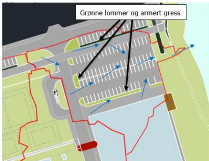
Figur 12: Delfelt 2 - avrenningsmønster og tiltak
