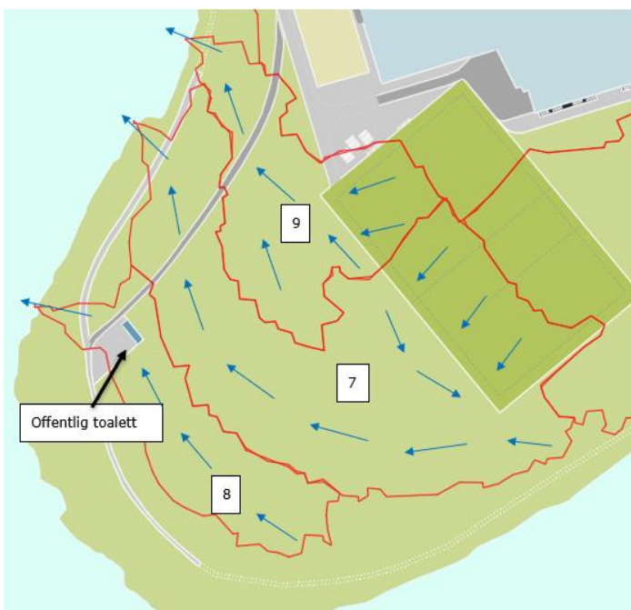
Figur 17: Deltfelt 7, 8 og 9 - avrenningsmønster og tiltak
