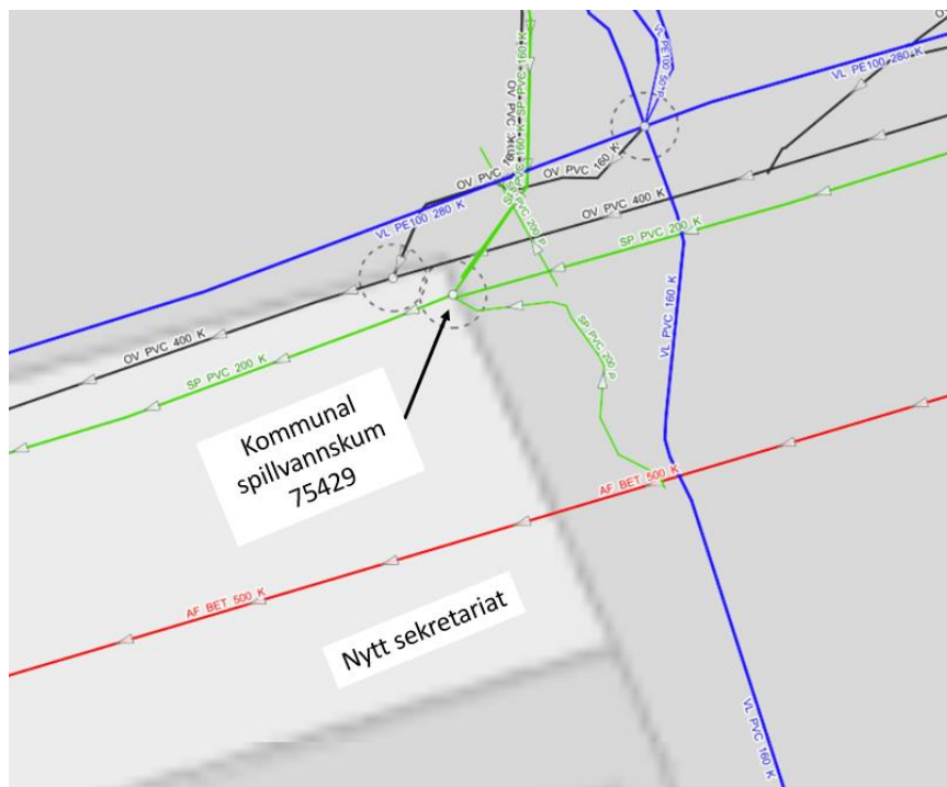
Figur 13: SP PVC 200 stikk ut fra kommunal spillvannskum 75429 (kilde: Gemini Ringerike)
