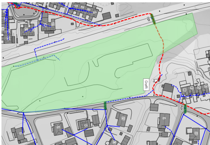
Figur 6.14 – Høyspentkabel og nettstasjon ved Begnaparken boligområde. (Kilde: Føie Nett)
