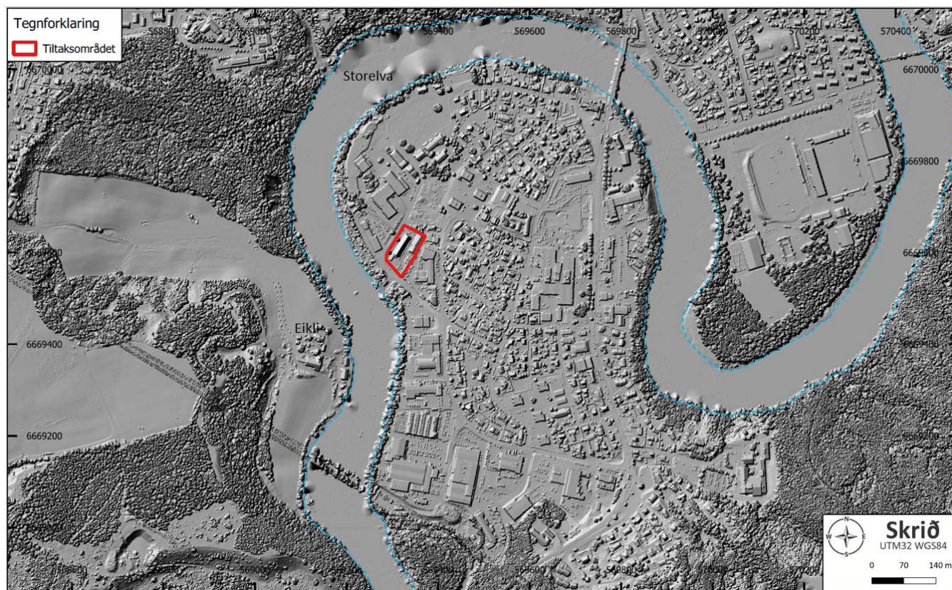
Figur 7 Skyggedata 2D illustrasjon ved bruk av LiDAR data (DOM). Av DOM dataene fremheves bygninger og vegetasjon på en god måte. Det er etablert vegetasjon langs store deler av Storelva. LiDAR datagrunnlag er 0,25 x 0,25 m. Kilde kartverket.no.
