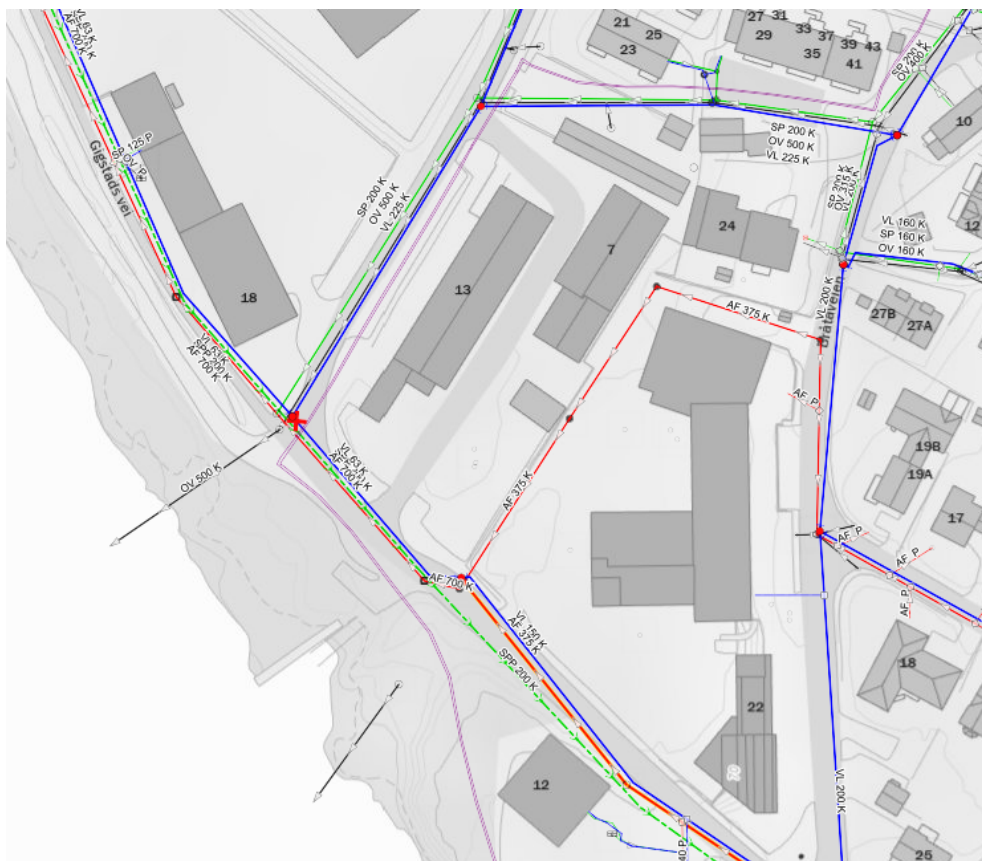
Figur 3 Planområdet og eksisterende offentlig vann- og avløpsnett. Ledningskart viser SP200, OV500, VL225 samt fjernvarme (lilla) i Gigstads vei vest av eiendom. Sør av eiendom ligger SPP 200, AF700 og VL63 samt fjernvarme. Øst av eiendommen ligger AF375.
