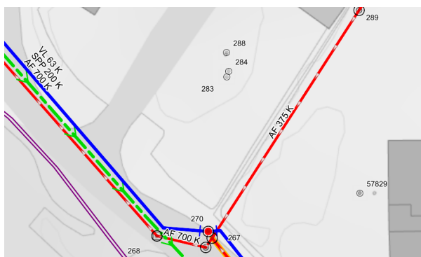
Figur 4 Eksisterende overvannskummer på utviklingseiendom – 283, 284 og 288. Antas tilknyttet AF 375 K i øst.
