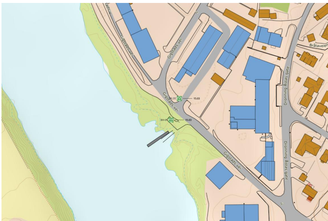
Figur 4-4: Borplan. BH-01 og BH-02 ble boret til 15 m dybde.
