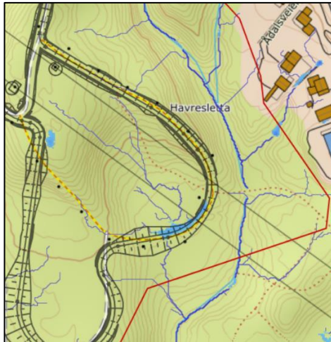
Figur 15: Avrenningslinje og vannoppsamling ved løypa. Vann samles opp i grøft og ledes til lavpunkt i grøften. Når lavpunktet er fylt opp renner vannet over løypa.
