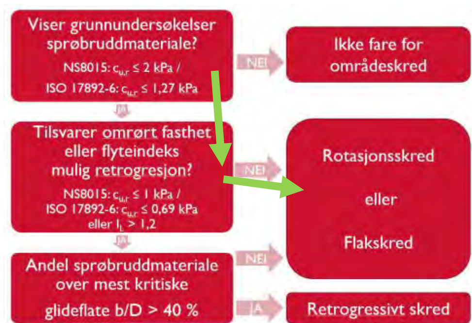
Figur 15: Flytskjema for vurdering av aktuell skredmekanisme hentet fra veilederen, figur 4.3 (NVE, 2020).
