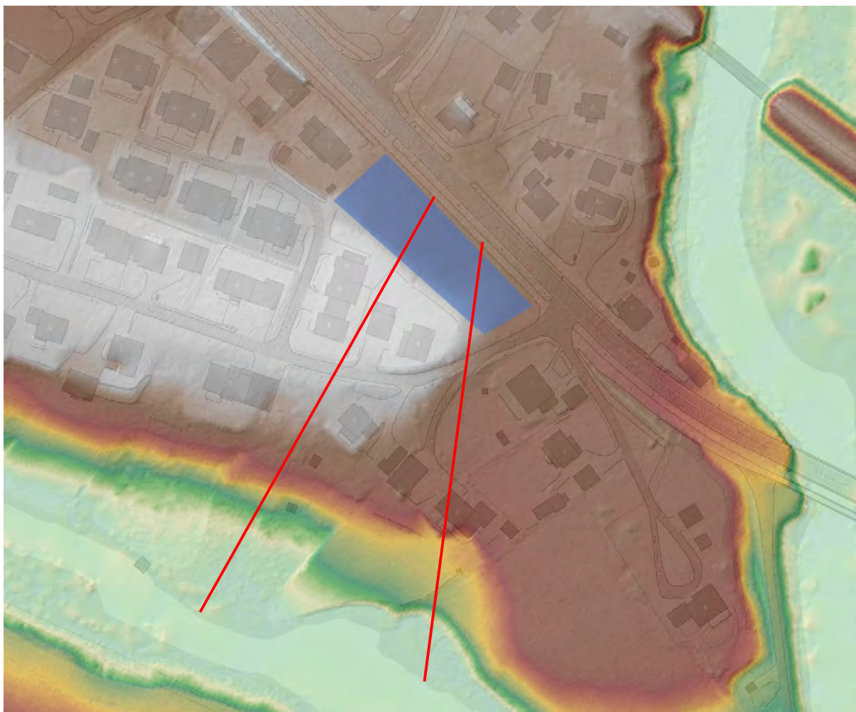
Figur 16: Utklipp fra Høydedata som viser topografien i området og snitt ut mot skråning i sørøst. Ut fra topografien (illustrert med farger) konkluderes det med at et flaskred utelukkes fordi terrenget flater ut i stor avstand fra tomten (blått felt).
