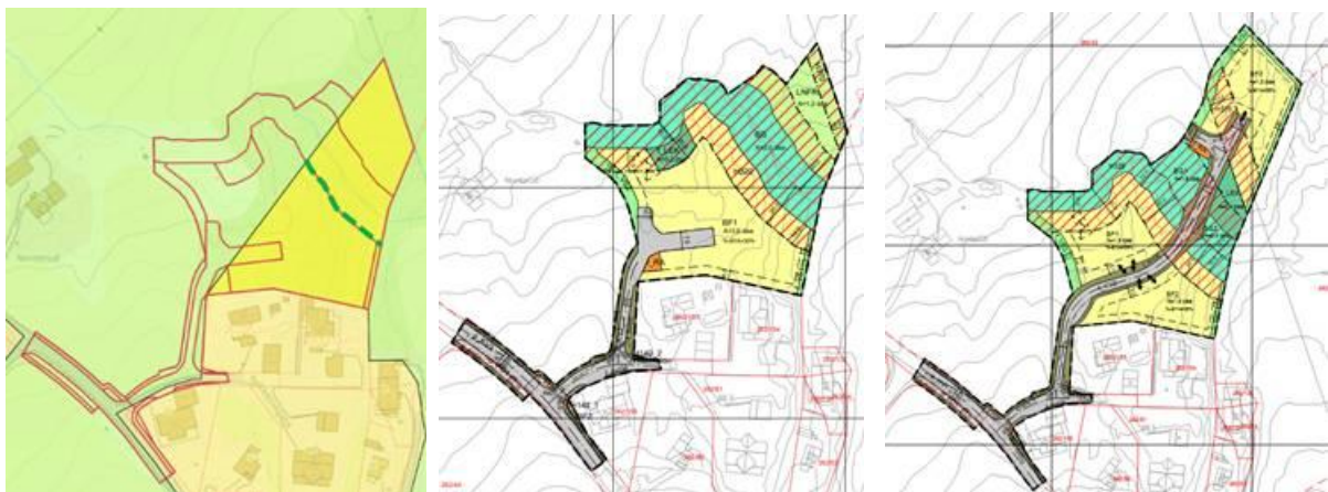
Figur 3. Forholdet mellom kommuneplanens arealdel og plangrensen. Arealdelen er vist til venstre, med plangrensen tegnet med rød linje. Plankartet slik det er nå er vist i midten. Det gamle plankartet er vist til høyre.
