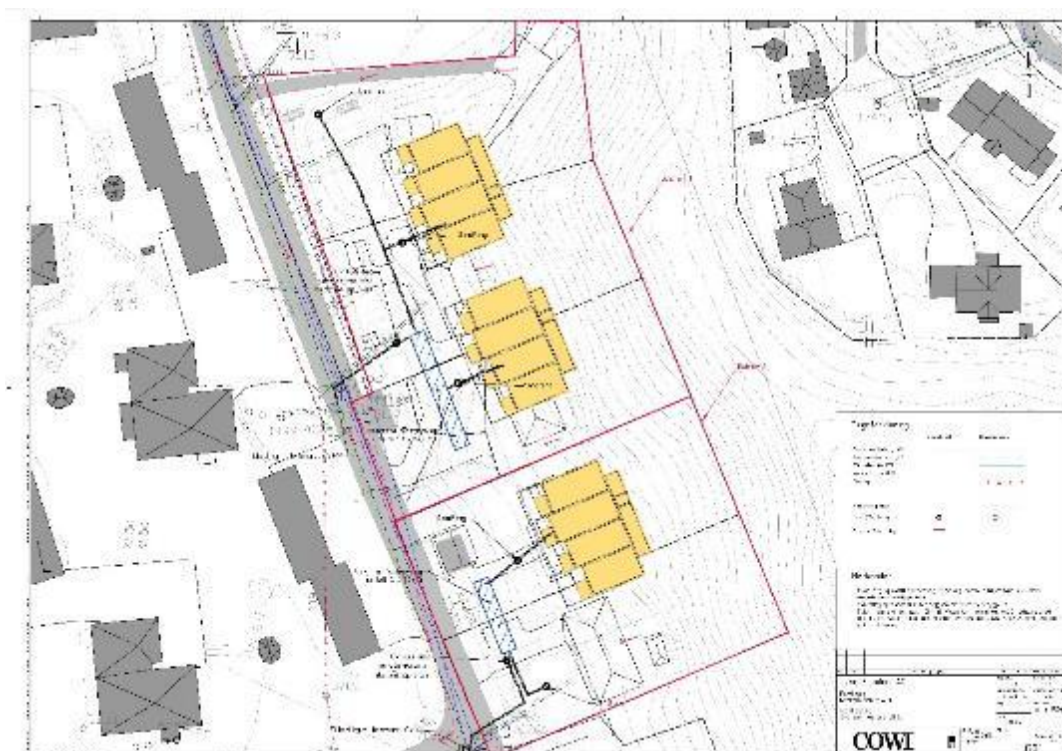
Løsning for overvann med fordrøyning.(Cowi)
