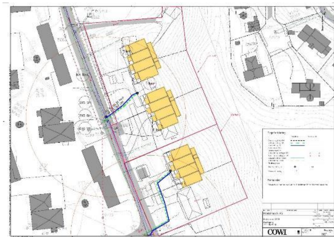
Tilkopling for vann og avløp (Cowi)
