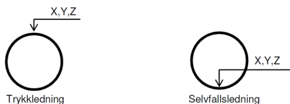
Figur 1. Måling av ledningshøyde
